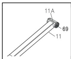
а. Закрепите правую опору педали (11) на рычаге (10), используя болт (M8x1.25x90mm)(98) и гайку (M8)(109). Не затягивайте болт и гайку. Убедитесь, что болт (98) соединяет втулку (69) и правую опору педали (11).
