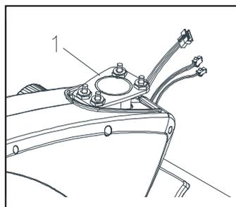
Примечание: Во избежание повреждений во время транспортировки гайки (M8) (109) закреплены на основной раме (1), как изображено на рисунке слева.
