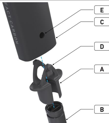
Батарея Di2 удерживается на месте в подседельном штыре с помощью монтажного зажима и должна быть установлена перед вставкой подседельного штыря в подседельную трубу.
